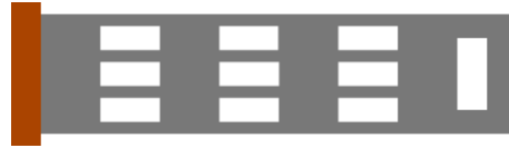
図 132 孔が 10 個のカンチレバー
