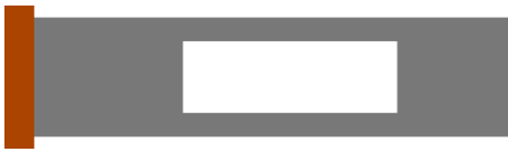
図 129 孔が 1 個のカンチレバー
