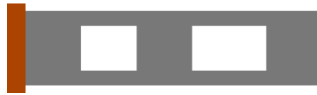
図 130 孔が 2 個のカンチレバー
