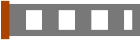
図 131 孔が 4 個のカンチレバー
